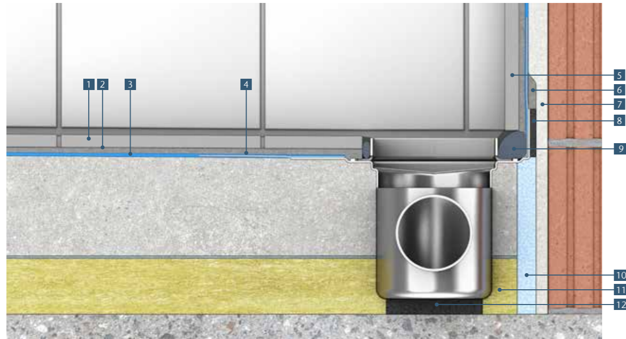
Beépítési javaslat az ACO Exclusive Plusz zuhanyfolyókához (padló rétegrend zajcsillapításra kialakítva)
